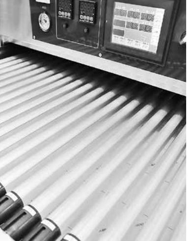
主露光を行う管型のLED光源。モニターでは主露光・洗い出し・乾燥・後露光時間をデジタル管理
