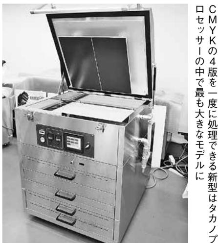
CMYKの4版を一度に処理できる新型はタカノプロセッサーの中で最も大きなモデルに
